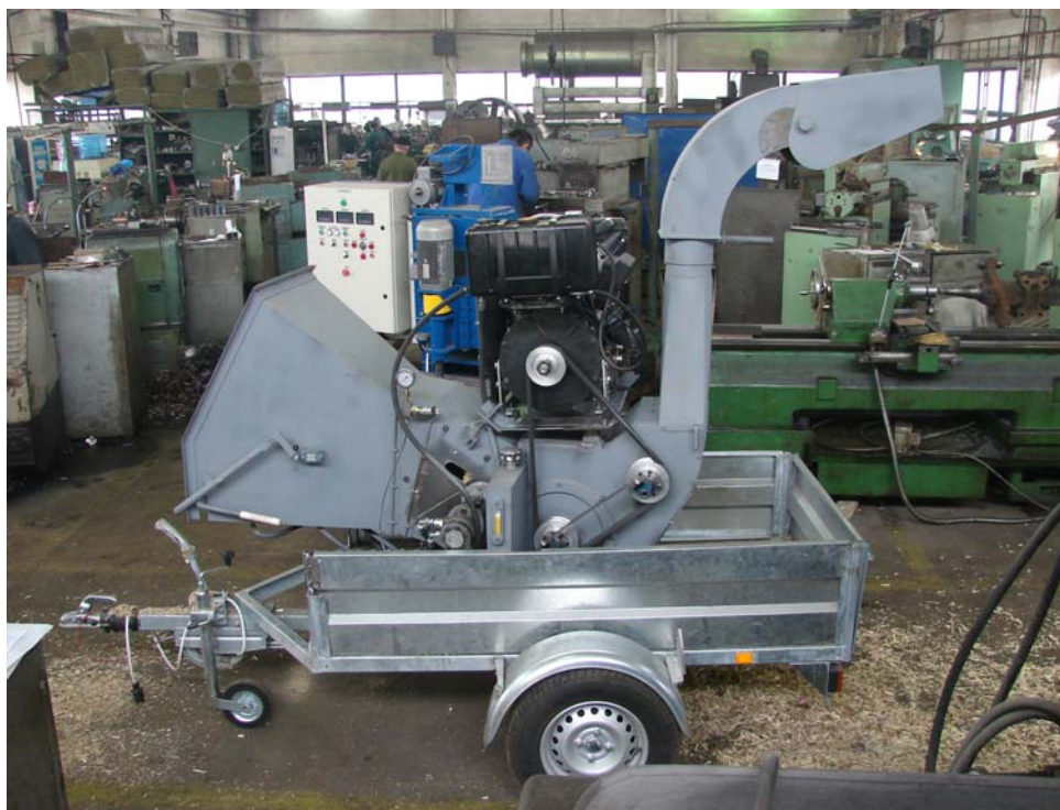
Fig. 2 Echipamentul de fragmentare-mărunțire material lemnos
