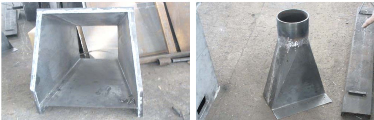
Fig. 7 Buncărul de alimentare și hornul de evacuare
